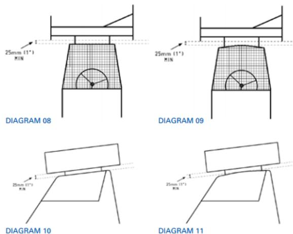
Der Motor muss sich Zentral in der Karosserie befinden. Gemessen wird zwischen den zwei Hauptrohren zur Kurbelwellen Mitte +/- 25mm
